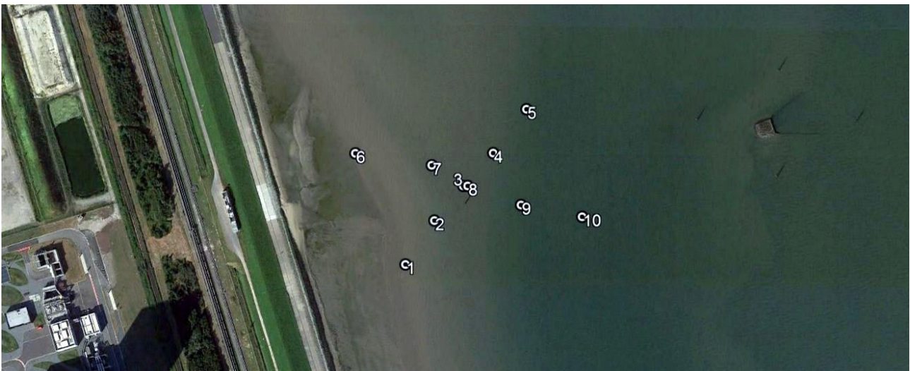
Abbildung 9: Lage der Probenahmestandorte für die Sedimentuntersuchungen Station 3 und 8 liegen unmittelbar am Ende der Fischrückführleitung; Quelle: MARINE SCIENCE SERVICE (2019b)
